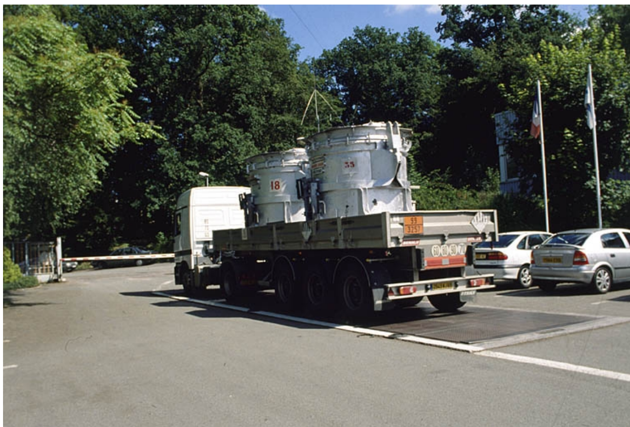
Camion chargé de deux poches d'aluminium liquide.
