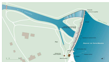
Plan schématique du réservoir de Pont, détail du barrage. Dess. Alain Morelière
