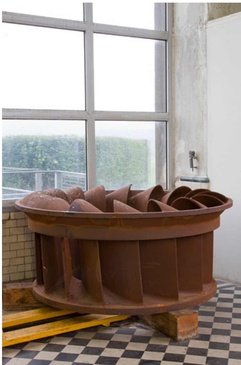
Centrale de la Prétière : turbine Francis déposée.
