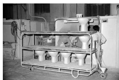
Atelier (9) : cabine d'émaillage. Phot. Laurent Poupard IVR43_19893901138Z
