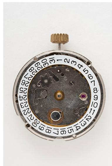
Mouvement FE 4612, vu côté cadran.
