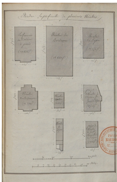
Etendue superficielle de plusieurs théâtres. S.d. [décennie 1800]. Celui projeté dans l'église Saint-Jean est visible au centre de la colonne de droite. Autr. auteur inconnu IVR26_20222100861NUC2A
