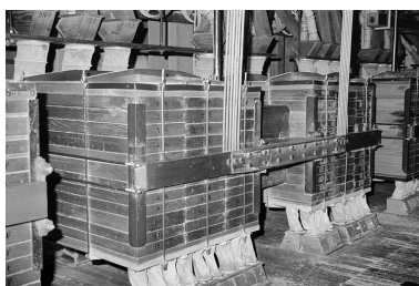
Atelier de fabrication (L), 3e étage : plansichter vu de trois quarts. Phot. Laurent Poupard IVR43_19893900602Z
