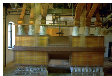
Atelier de fabrication (L), 3e étage : plansichter en fonctionnement. Phot. Yves Sancey IVR43_19893900603ZA
