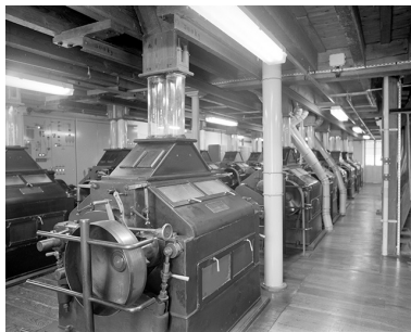
Atelier de fabrication (L), 1er étage : rangée d'appareils à cylindres. Phot. Yves Sancey IVR43_19893900598X
