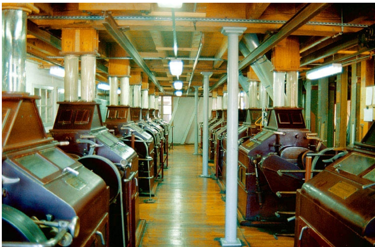
Atelier de fabrication (L), 1er étage : vue d'ensemble des appareils à cylindres.
