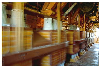
Atelier de fabrication (L), 3e étage : vue d'ensemble des plansichters en fonctionnement. Phot. Yves Sancey IVR43_19893900601ZA
