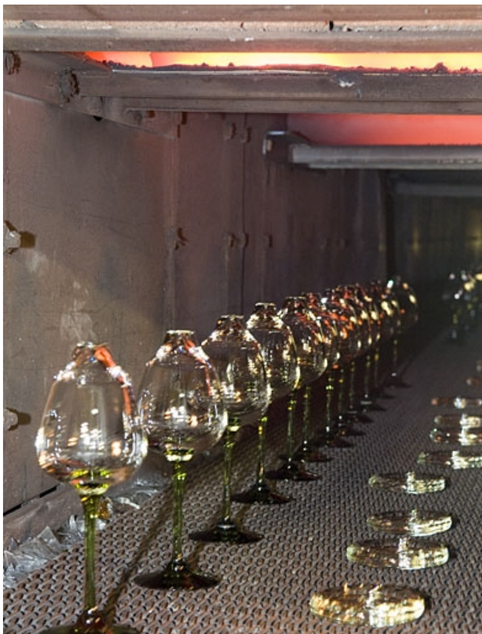
Intérieur du four à recuire (arche).
