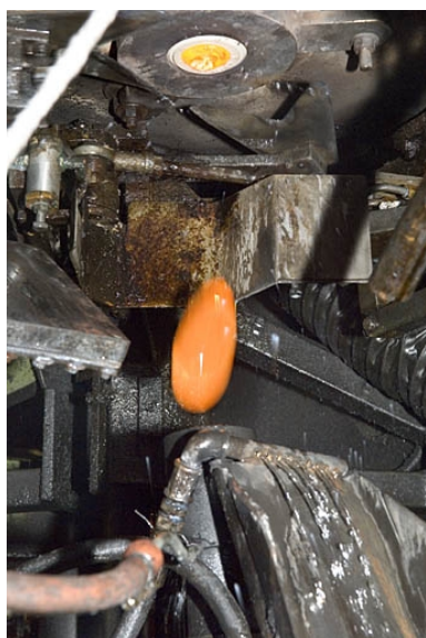
Mouleuse de tuile de verre. Chute de matière avant moulage. Phot. Jérôme Mongreville IVR43_20077000936NUCA
