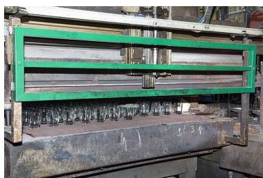
Four à recuire (atelier Articles de table). Phot. Jérôme Mongreville IVR43_20077000938NUCA
