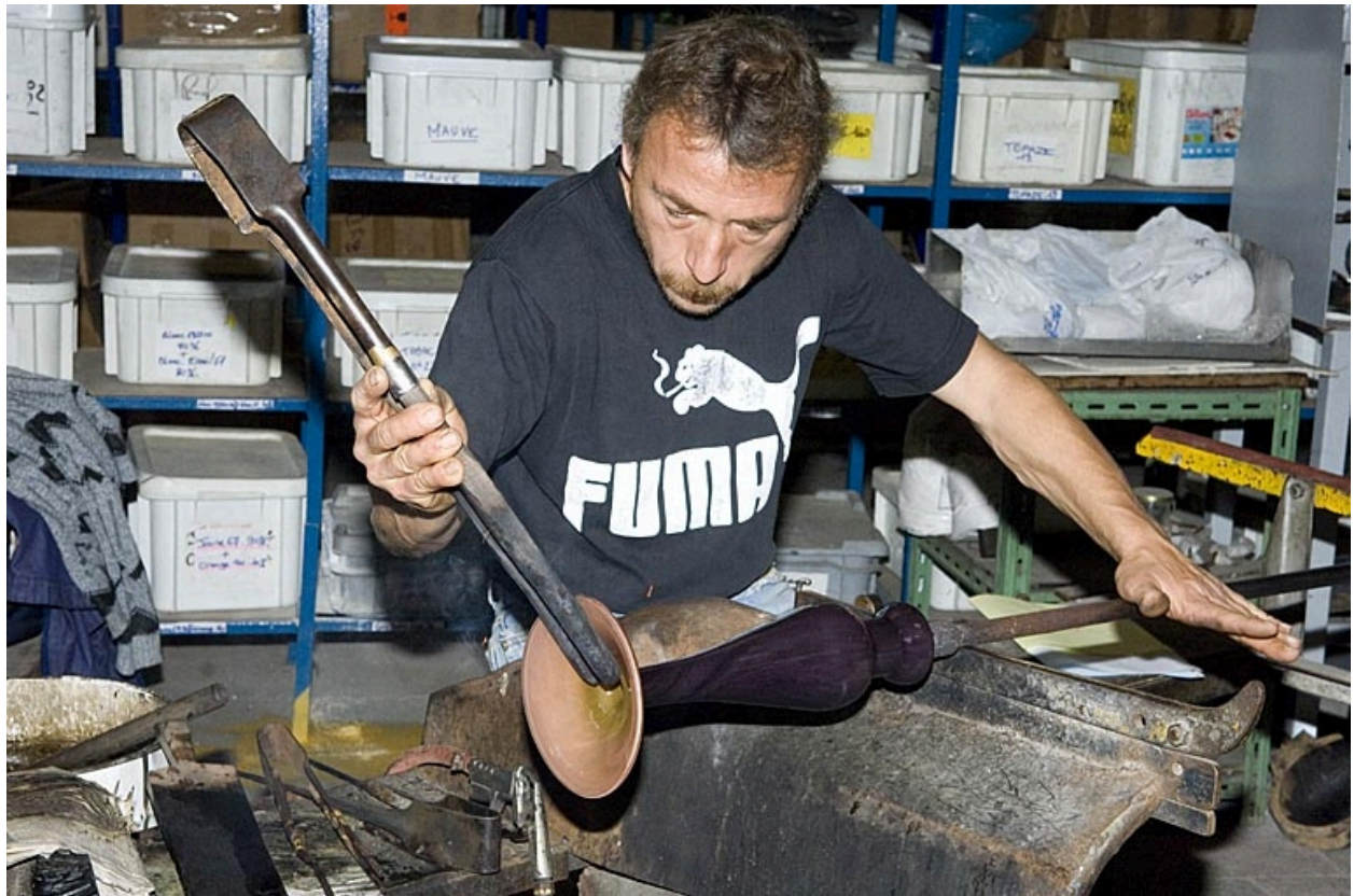
Façonnage du pied de la lampe.
