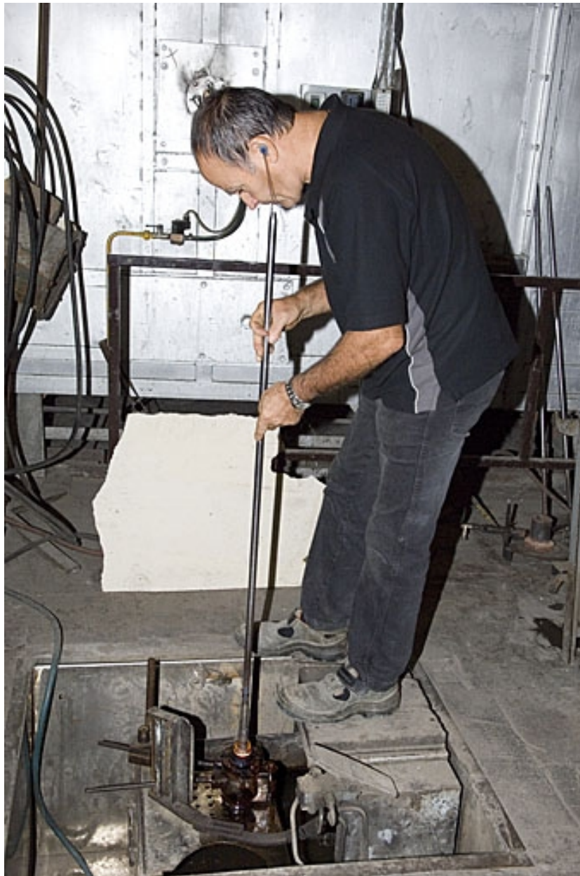
Soufflage dans le moule, dit "gamin mécanique".
