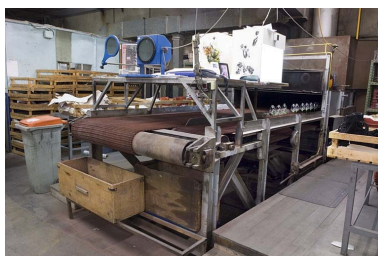
Sortie du four à cuire (arche). Phot. Jérôme Mongreville IVR43_20077000935NUCA
