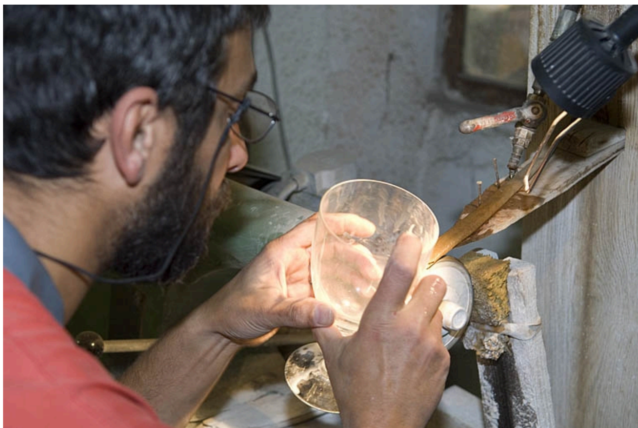
Atelier de finition ou parachèvement. Taille de verre (4).
