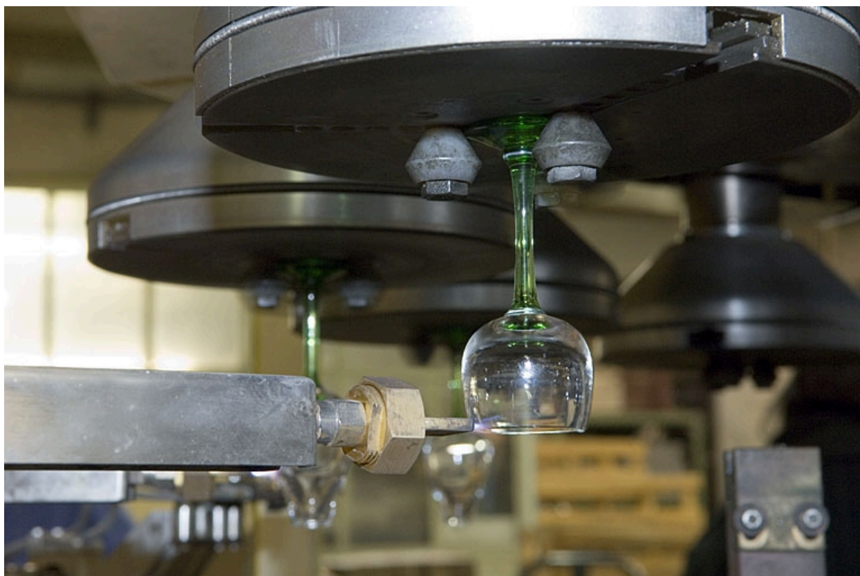
Flettage (ou rebrûlage) des bords d'un verre.
