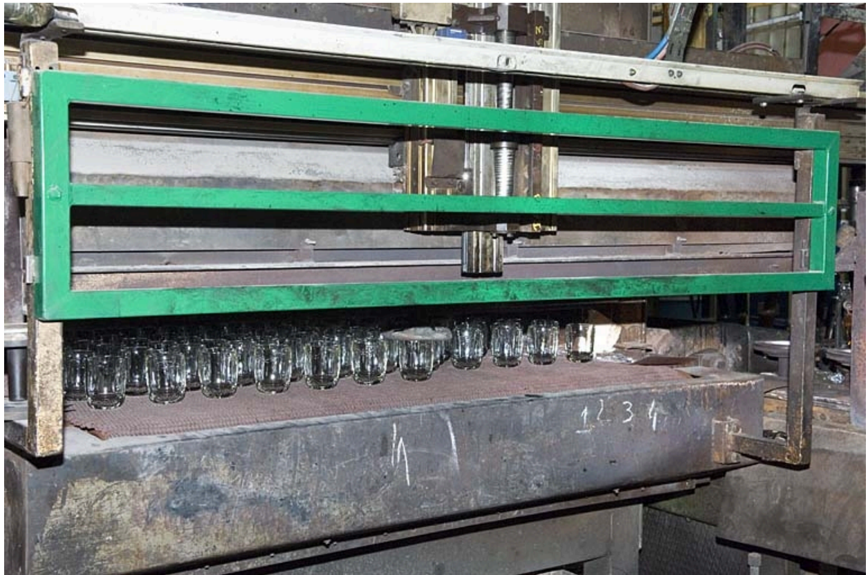
Four à recuire (atelier Articles de table).
