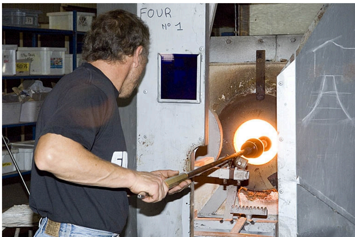
Four à réchauffer.
