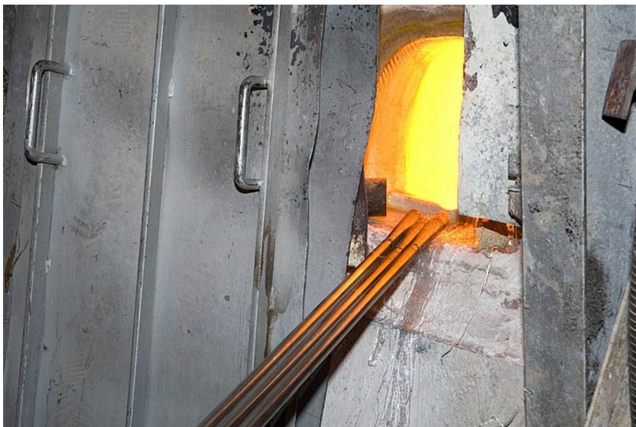
Four à pots. Canes et ouverture.
