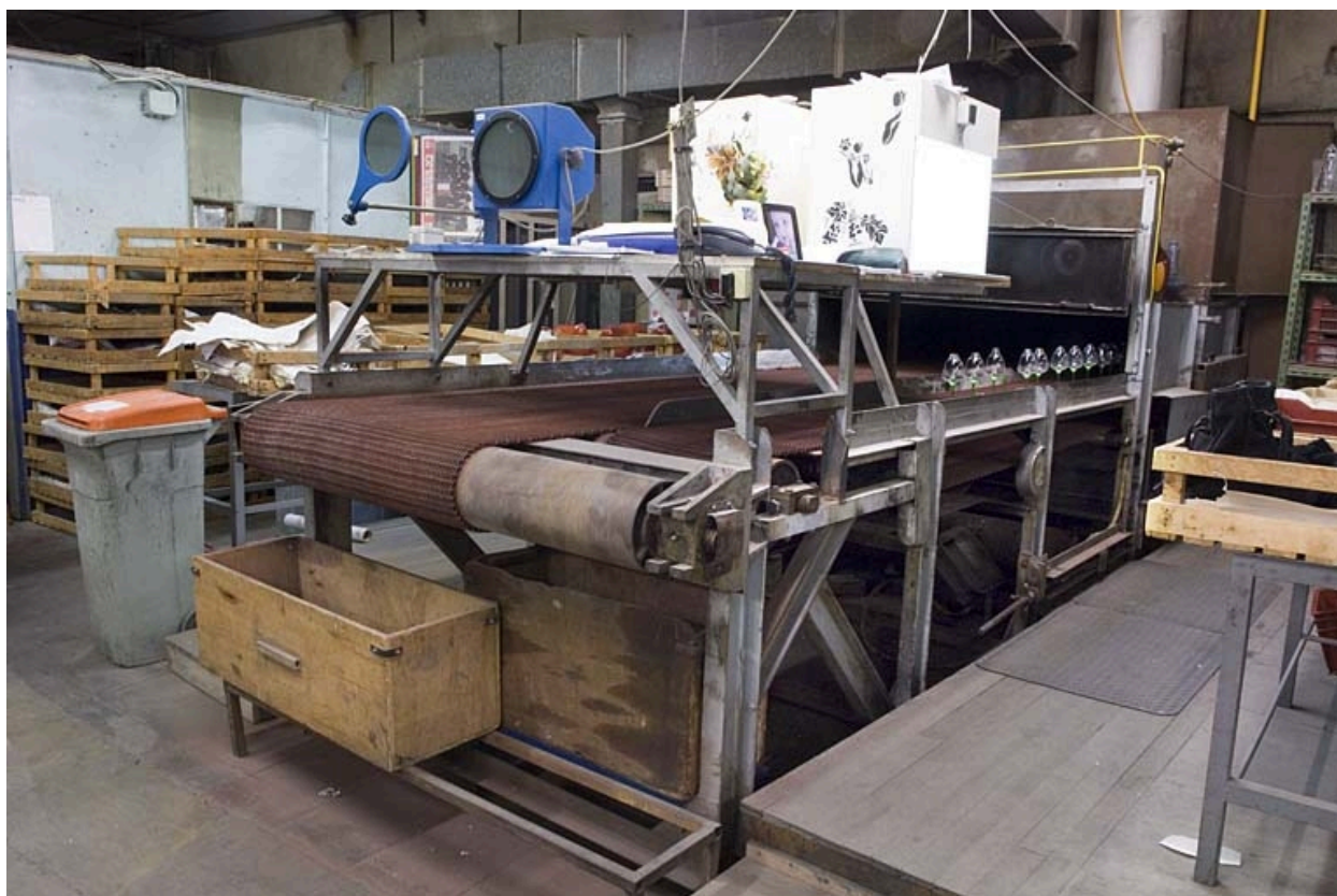
Sortie du four à recuire (arche).
