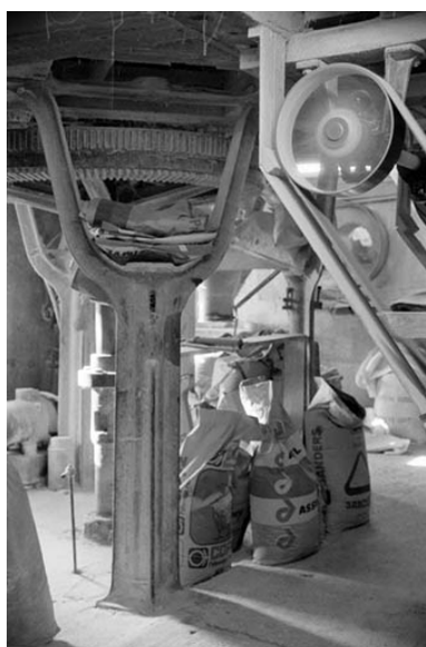
Transmission et support de meules (beffroi). Phot. Laurent Poupard IVR43_19883900702Z
