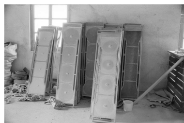
Tamis du plansichter. Phot. Laurent Poupard IVR43_19883900707Z
