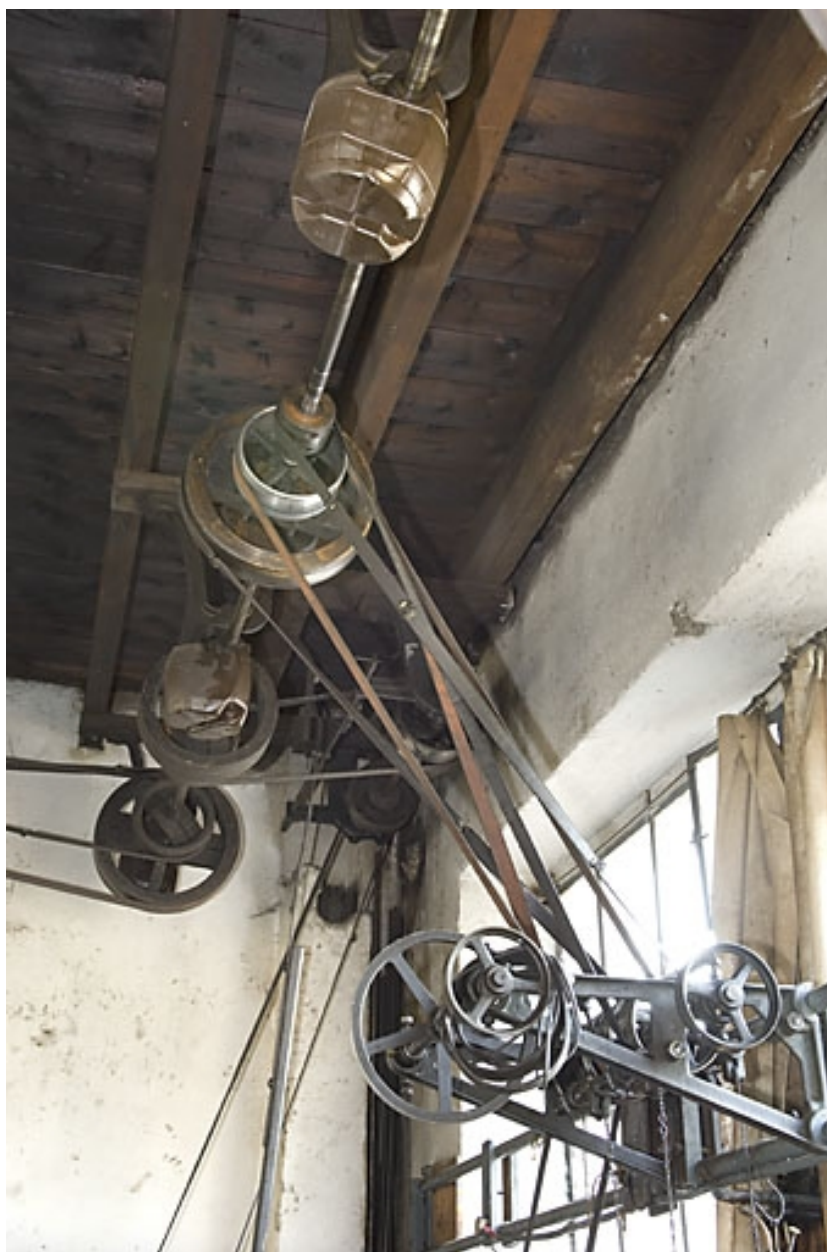
Arbre et console de transmission du tour horizontal (C).
