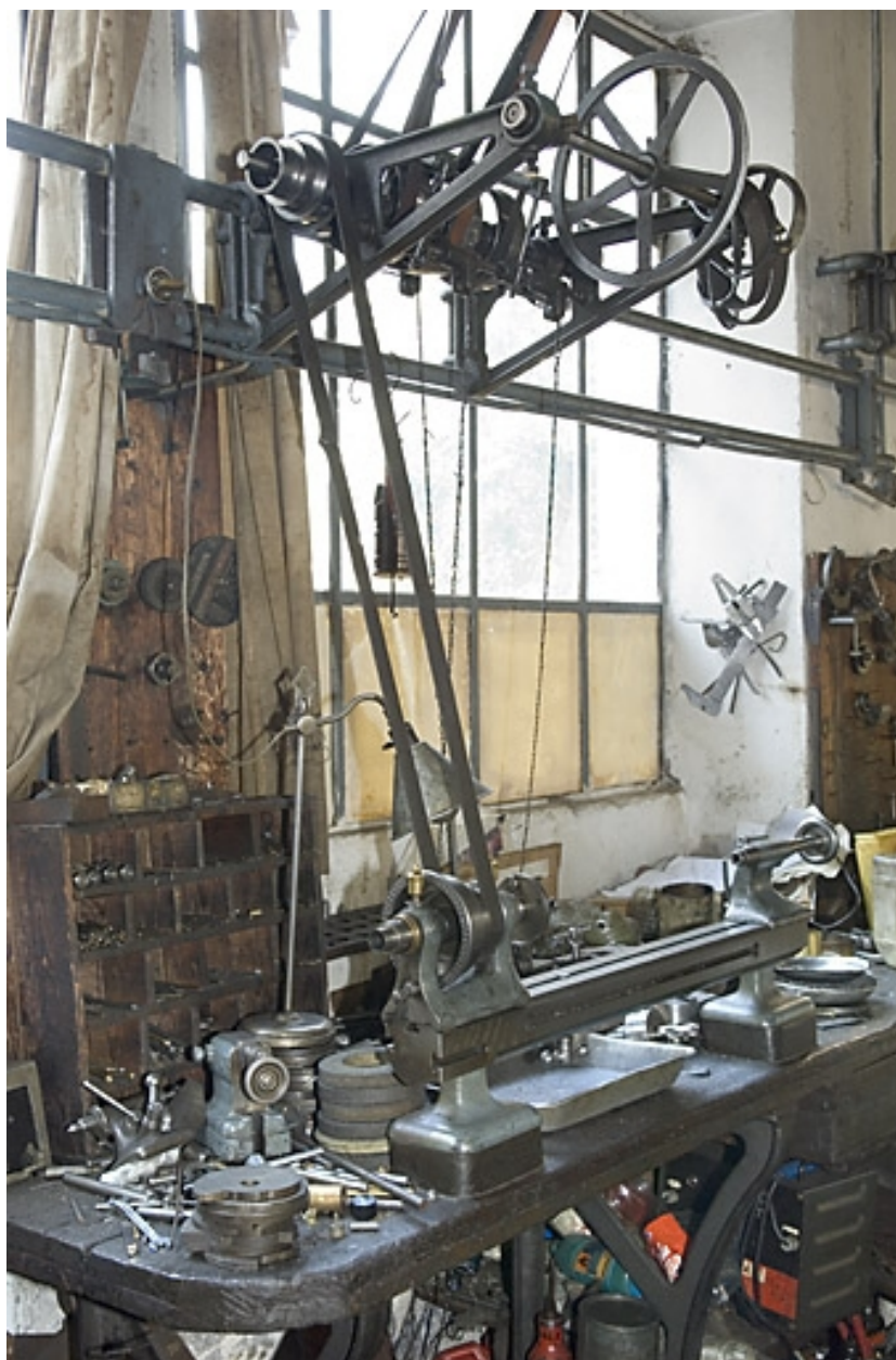
Tour horizontal Waltham (B) et sa transmission.
