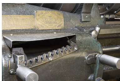
Tour horizontal parallèle Selson (A). Détail de la boîte de vitesses. Phot. Jérôme Mongreville IVR43_20082500050NUC2A
