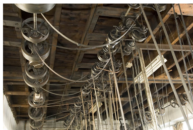
Poulies et courroies en cuir du système de transmission. Phot. Jérôme Mongreville IVR43_20082500026NUC2A
