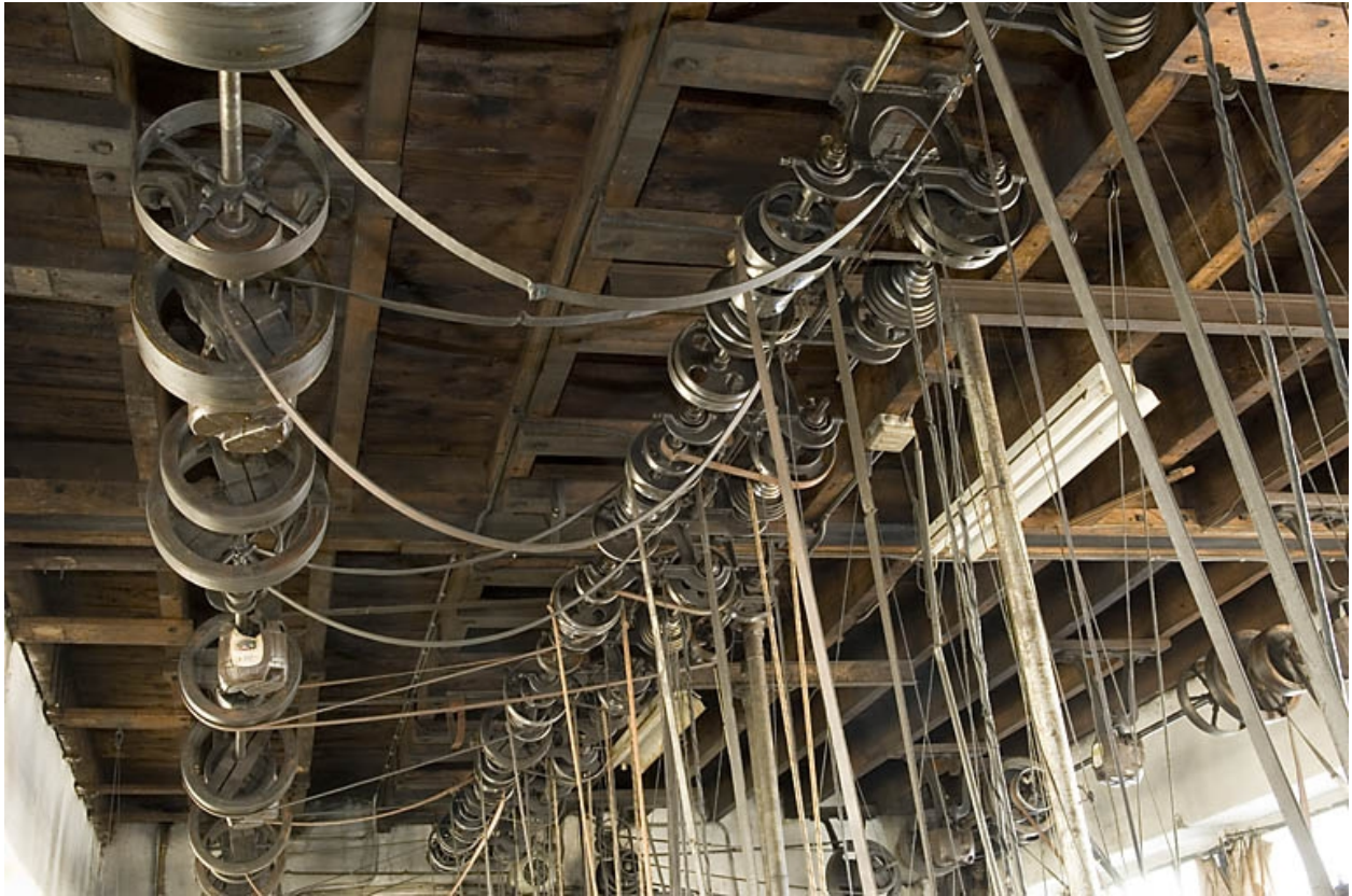
Poulies et courroies en cuir du système de transmission.
