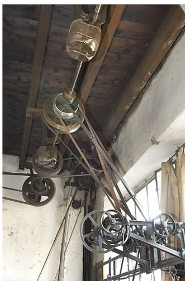
Arbre et console de transmission du tour horizontal (C). Phot. Jérôme Mongreville IVR43_20082500045NUC2A
