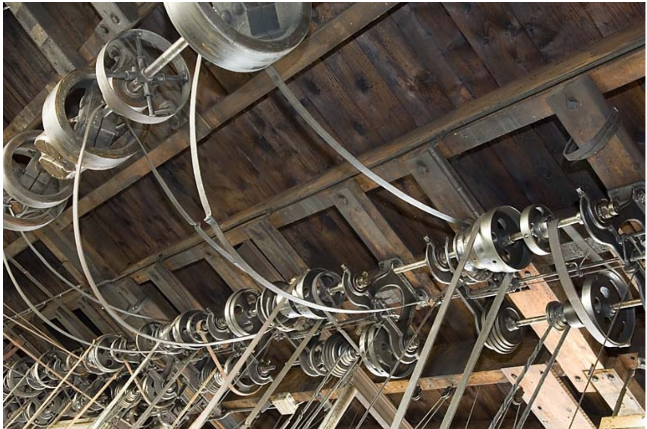
Les arbres de transmission équipés des poulies et des courroies.
