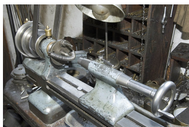
Tour horizontal Waltham (B). Détail de la poulée fixe et de la poulée mobile. Phot. Jérôme Mongreville IVR43_20082500042NUC2A
