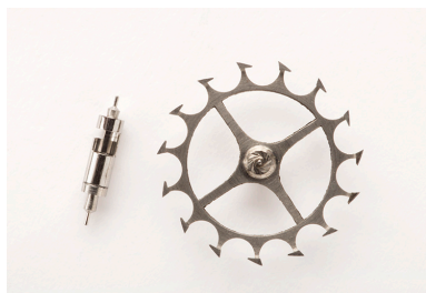
Cylindre et sa roue de cylindre. Phot. Sonia Dourlot IVR43_20152500227NUC4AQ
