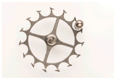
Position du cylindre et de sa roue, vue à la verticale. Phot. Sonia Dourlot IVR43_20152500228NUC4AQ
