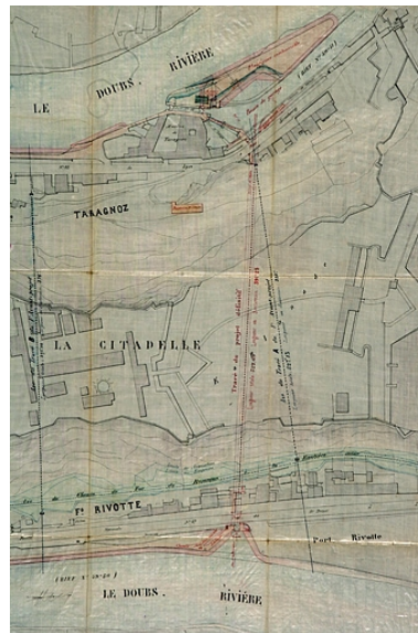
Dérivation sous la citadelle de Besançon. Plan de la dérivation et de ses abords [détail : tracé définitif, en rouge], 1877. Phot. Yves Sancey, Phot. Rascol IVR43_20062500053NUCA
