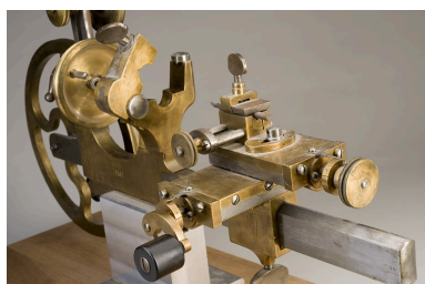
Chariot porte-outil et support de l'ensemble arbre-plateau (quill). Phot. Marc Loukachine IVR43_20122500081NUC4A
