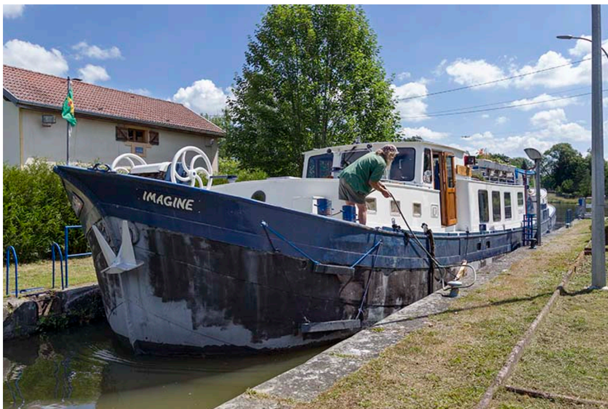
Bâteau en train de s'amarrer sur une bitte de l'écluse.
