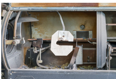
Projecteur côté jardin, lanterne : lampe à arc, en position de fonctionnement. Phot. Pierre-Marie Barbe-Richaud IVR26_20222100053NUC4A
