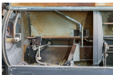
Projecteur côté jardin, lanterne : lampe à arc, en position d'arrêt. Phot. Pierre-Marie Barbe-Richaud IVR26_20222100052NUC4A
