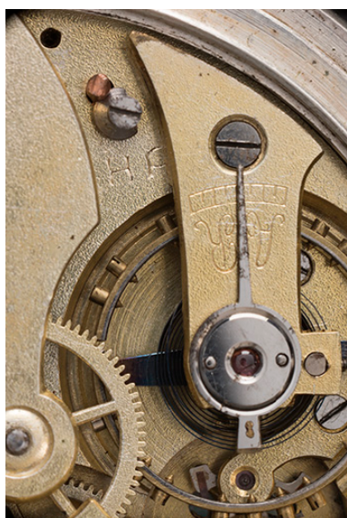
Mouvement : marque du fabricant (HP) et pont du balancier.
