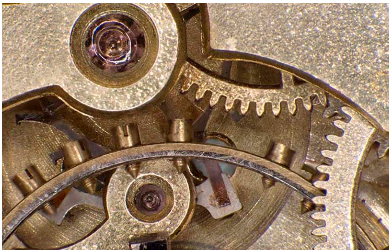
Mouvement, détails : contre-pivot en rubis, balancier à vis, ancre (avec ses palettes en rubis) et roue d'ancre.
