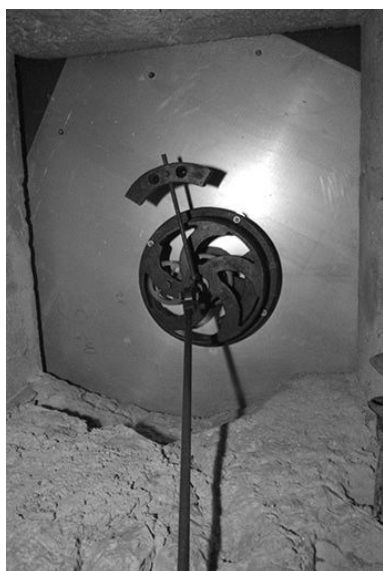
Mécanisme des aiguilles du cadran extérieur sud. Phot. Jérôme Mongreville IVR43_20003900725Z
