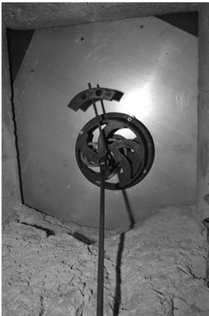
Mécanisme des aiguilles du cadran extérieur sud.
