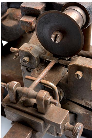
Système de fixation de la roue de cylindre et meule en carborandum, vue en plongée.
