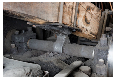
Came en appui contre la plaque de renfort du manche. Phot. Sonia Dourlot IVR43_20172501570NUC4A
