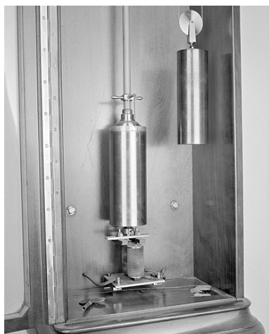
Balancier et électroaimant. Phot. Jérôme Mongreville IVR43_20032501032X
