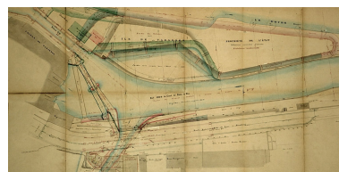
Dérivation sous la citadelle de Besançon. Plan des ouvrages à l'extrémité aval de la dérivation, 1877. Phot. Yves Sancey, Phot. Rascol IVR43_20062500091NUCA
