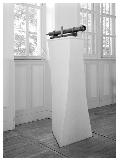
Mire nord de la lunette méridienne : pilier intérieur, avec son collimateur. Phot. Jérôme Mongreville IVR43_20042500018V
