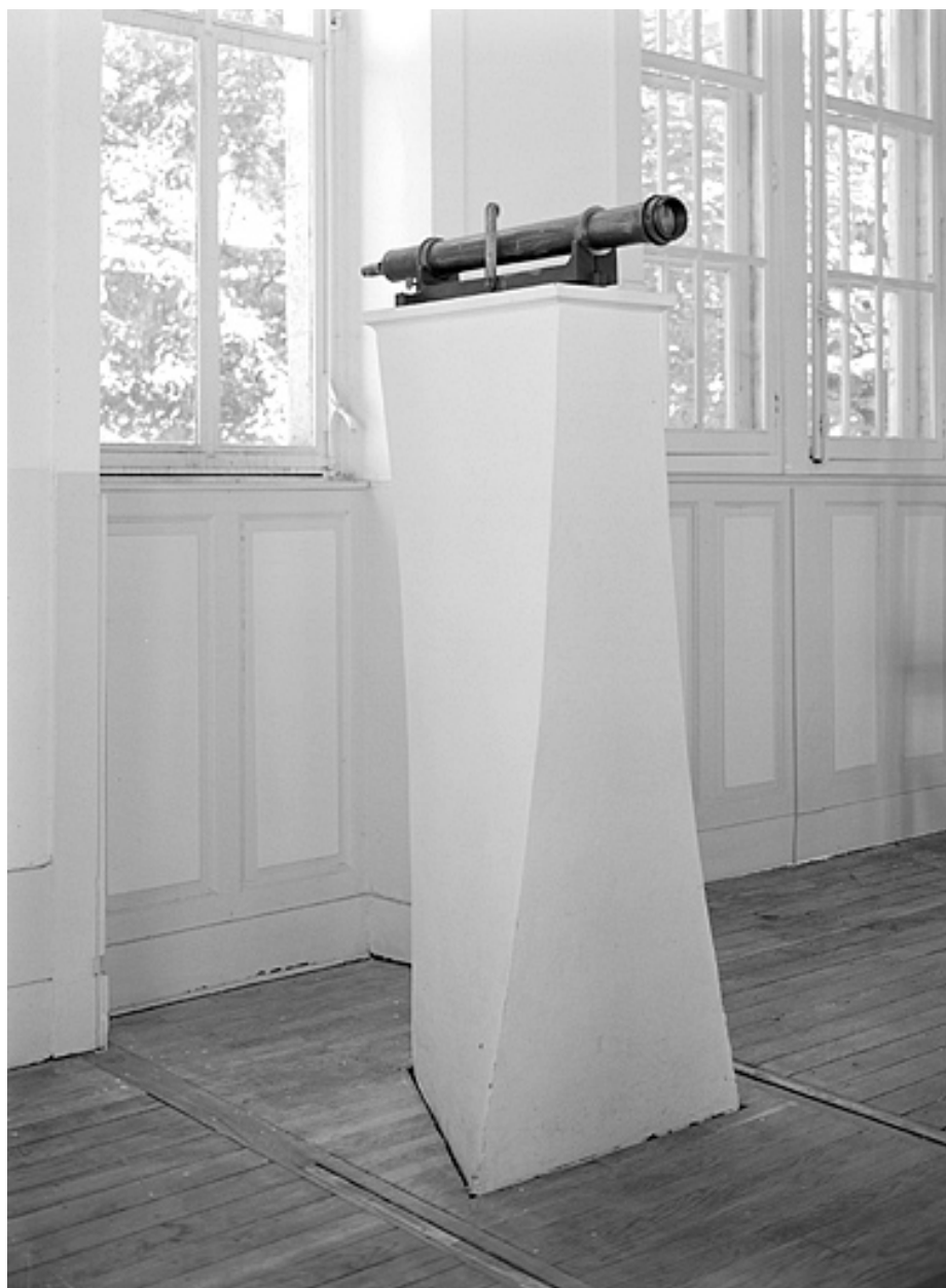
Mire nord de la lunette méridienne : pilier intérieur, avec son collimateur.
