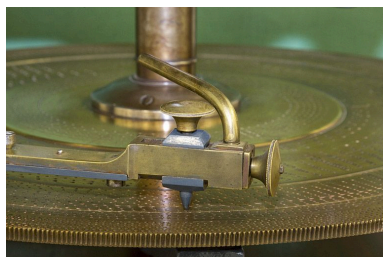
Extrémité du palpeur. Phot. Yves Sancey IVR43_20123900085NUC2A
