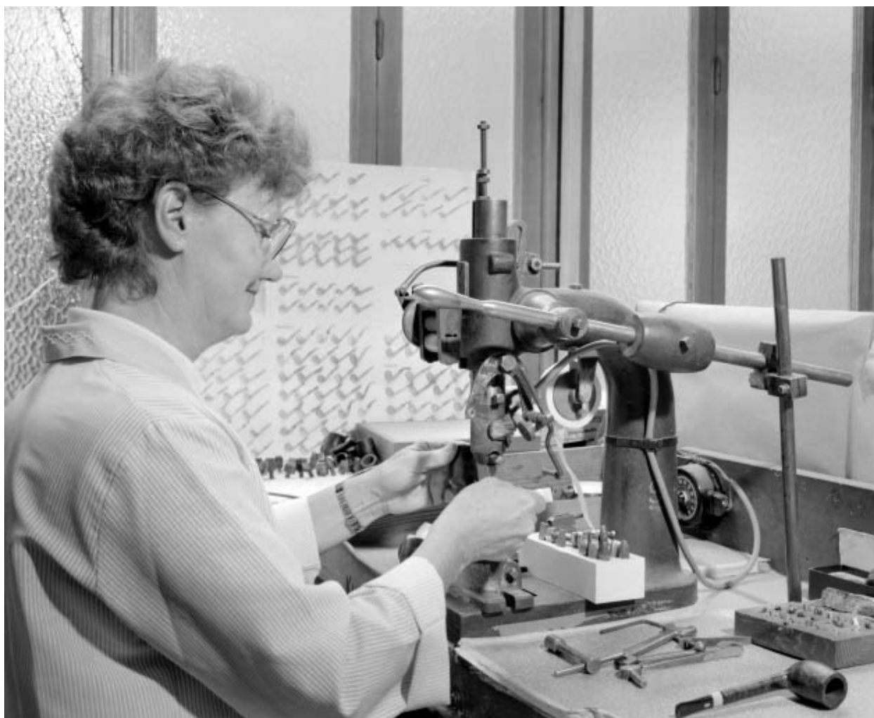
Marquage d'une pipe.
