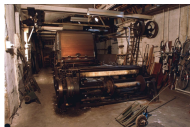
Vue d'ensemble. Au premier plan : bobines d'enroulage après l'opération d'encollage. Phot. Yves Sancey IVR43_19999000245ZA
