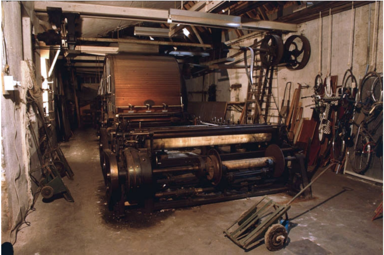
Vue d'ensemble. Au premier plan : bobines d'enroulage après l'opération d'encollage.
