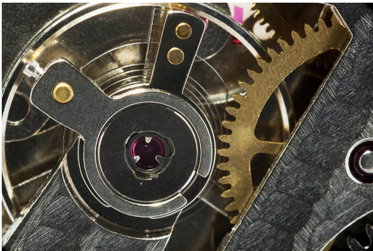
Mouvement FE 233-68-E-21 : l'amortisseur de chocs Epsilon Antichoc 108.
