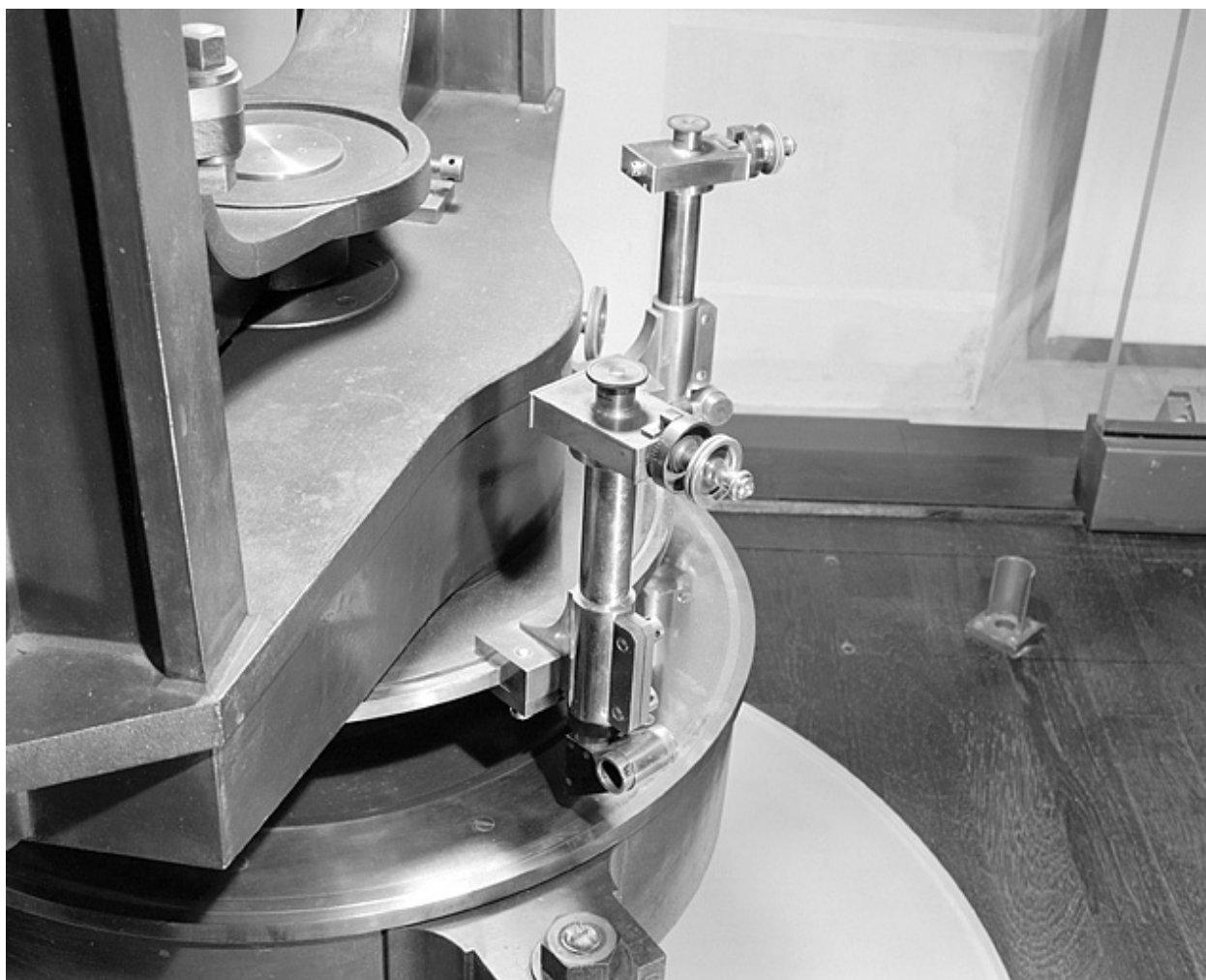
Altazimut : détail des vis micrométriques sur la monture.
