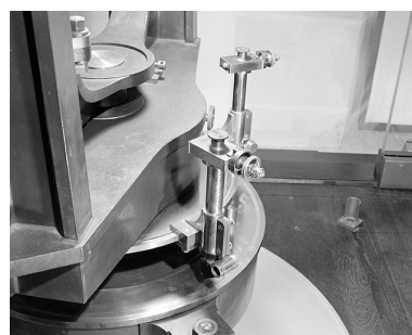
Altazimut : détail des vis micrométriques sur la monture. Phot. Yves Sancey IVR43_20022501285X
