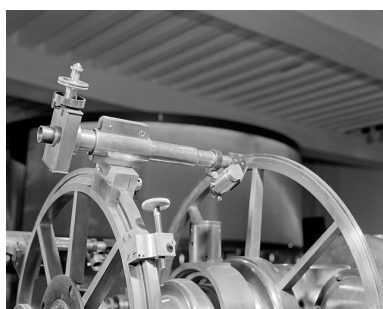
Altazimut : détail du système de réglage et de lecture du cercle. Phot. Yves Sancey IVR43_20022501289X
