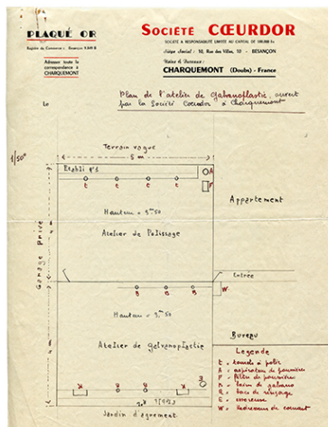
Plan de l'atelier de galvanoplastie ouvert par la société Coeurdor à Charquemont, 3 mai 1950. Dessiné sur un papier à en-tête. Autr. auteur inconnu IVR43_20152500525NUC4A
