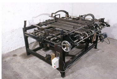
Machine à plier (plieuse Mentges Folder Co. de l'ensemble de la presse à cylindre Voirin) : vue d'ensemble Phot. Jérôme Mongreville IVR43_20023900370ZA
