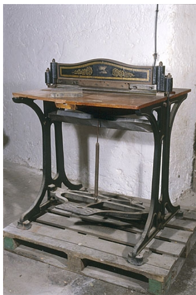
Machine à découper par poinçon (machine à perforer Barclay) : vue d'ensemble. Phot. Jérôme Mongreville IVR43_20023900354ZA
