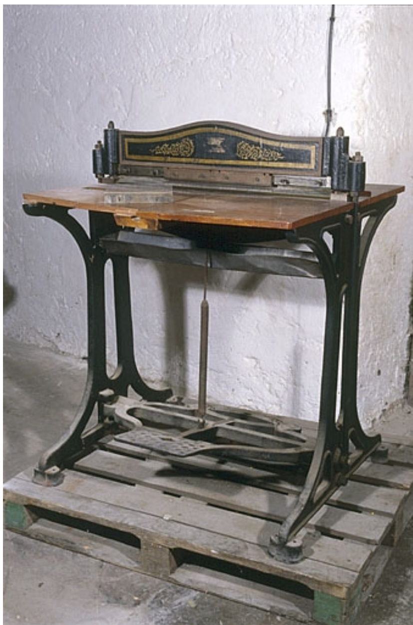
Machine à découper par poinçon (machine à perforer Barclay) : vue d'ensemble.
