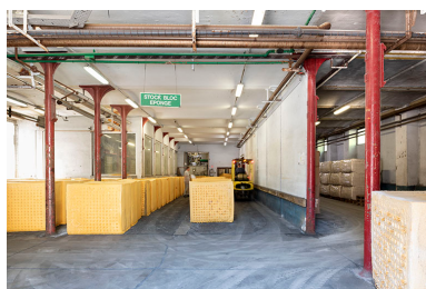
Fabrication : stockage temporaire des blocs juste démoulés.
