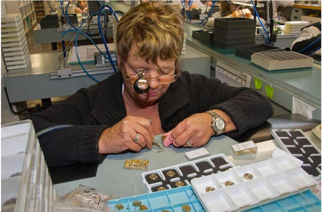
Atelier de fabrication : pose des aiguilles.
