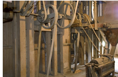
Système d'élévation, poulies, courroies et brosse à son (2e étage). Phot. Jérôme Mongreville IVR43_20067000338NUCA
