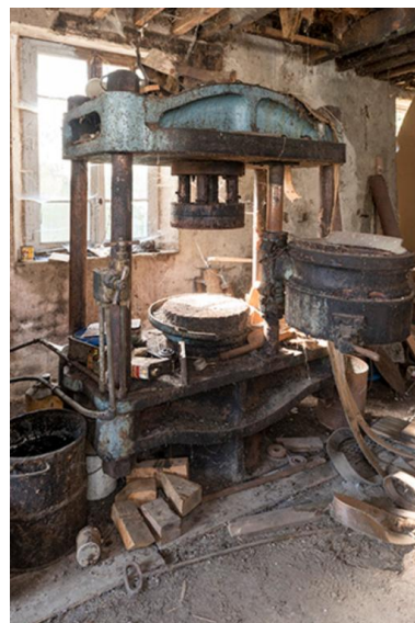
machine du rez-de- chaussée: presse hydraulique Phot. Sonia Dourlot IVR43_20167001306NUC4A
