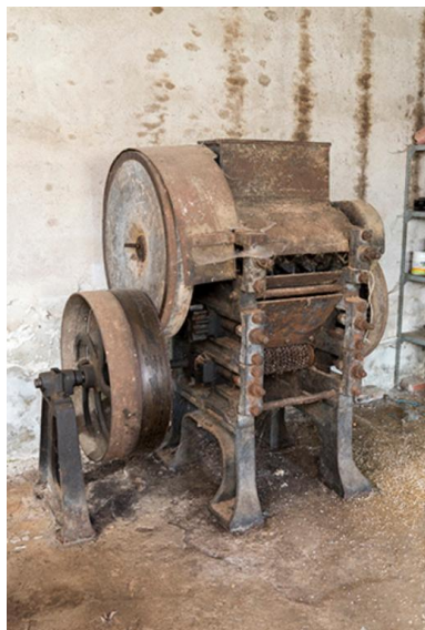
Machine du rez-de-chaussée: broyeur à tourteaux Phot. Sonia Dourlot IVR43_20167001308NUC4A
