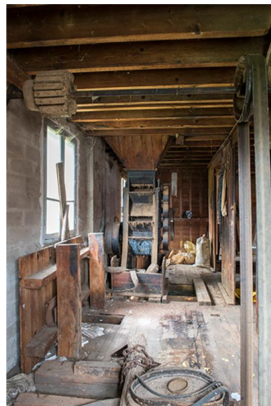
Vue du système de poulie et courroie et de trémie et broyeur à grains, au premier étage Phot. Sonia Dourlot IVR43_20167001310NUC4A
