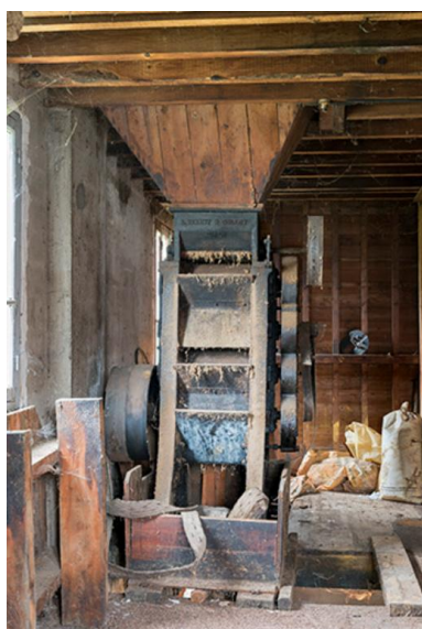
Broyeur et sa trémie situés au premier étage Phot. Sonia Dourlot IVR43_20167001311NUC4A
