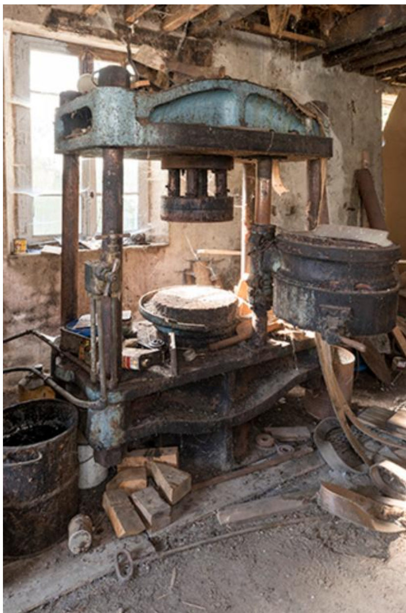
machine du rez-de-chaussée: presse hydraulique
