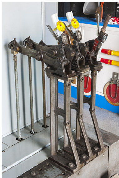
Gare de Port-d'Atelier, poste d'aiguillage : manettes de commande. Phot. Jérôme Mongreville IVR43_20127000568NUC4A
