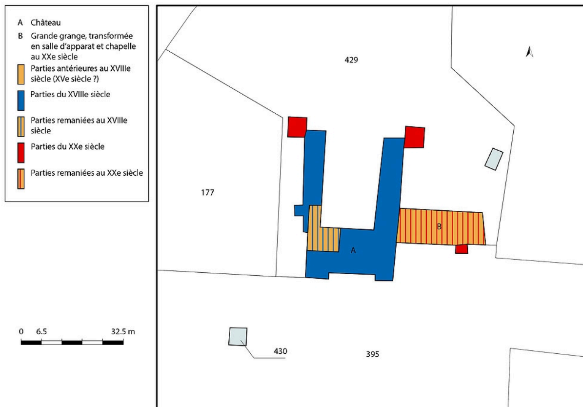
Plan de masse et de situation du château de Chaumont, présentant ses différentes phases de constructions. Extrait du plan cadastral, 2020, section B, échelle 1/3250.
