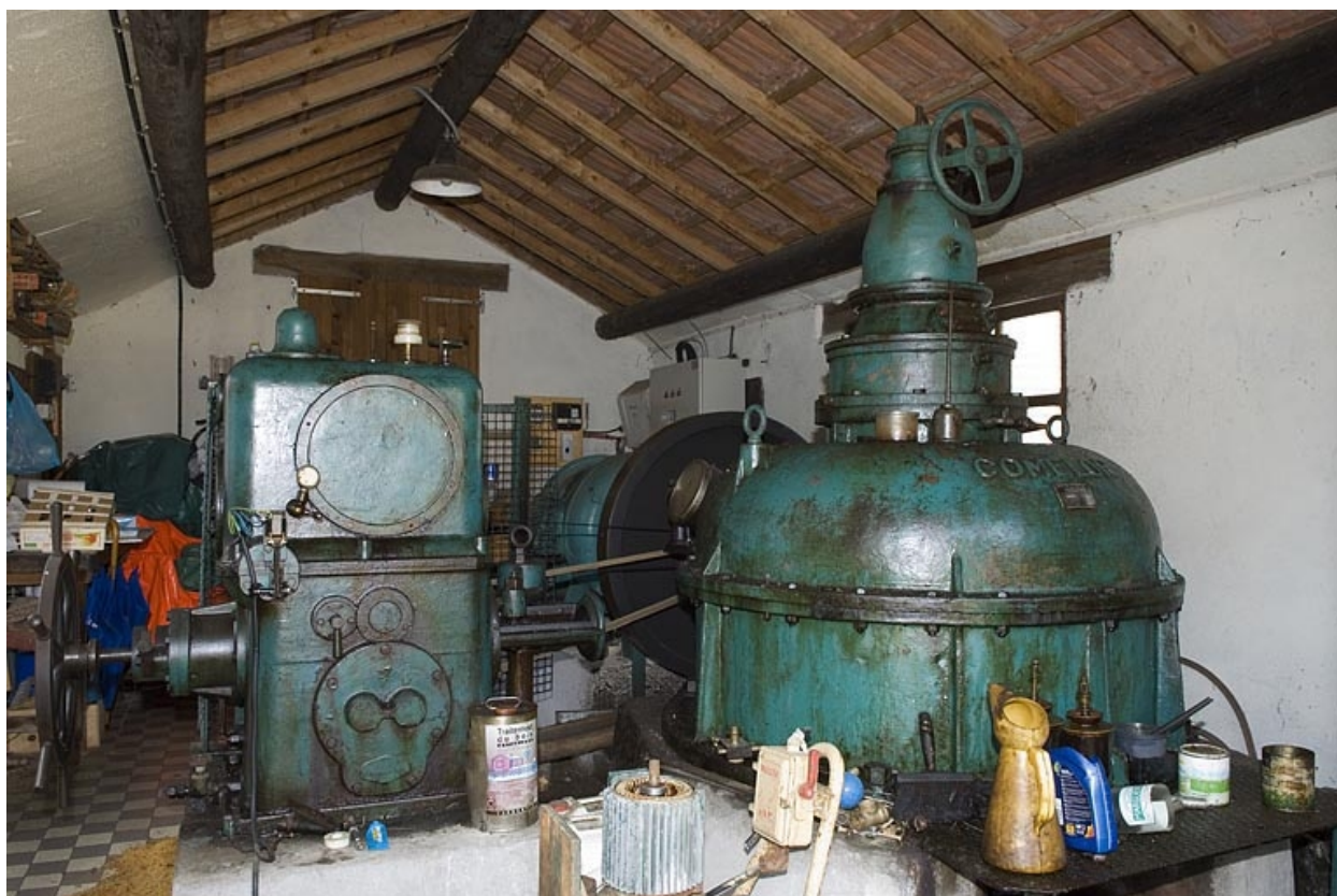
Intérieur de la salle des machines (sud). Turbine Dumont et multiplicateur Comelor.
