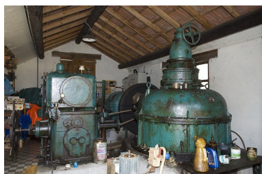
Intérieur de la salle des machines (sud). Turbine Dumont et multiplicateur Comelor. Phot. Jérôme Mongreville IVR43_20067000304NUCA
