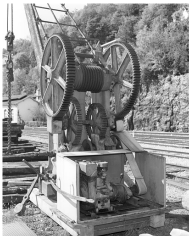
Pivot et treuil, côté moteur. Phot. Jérôme Mongreville IVR43_20013900620X
