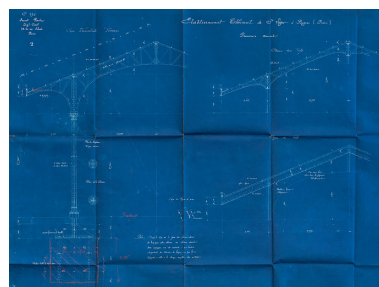
Promenoirs d'Ernest Panz (1895) : détails de l'assemblage des fermes métalliques. Phot. Pierre-Marie Barbe-Richaud, Autr. Ernest Panz IVR26_20205800243NUC2A
