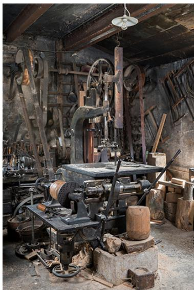
Forge : scie à ruban et mortaiseuse
