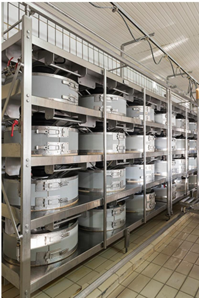
Atelier de fabrication : installation de pressage pneumatique.
