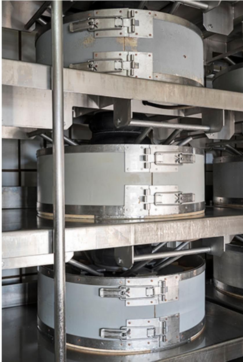
Atelier de fabrication : trois moules dans l'installation de pressage.
