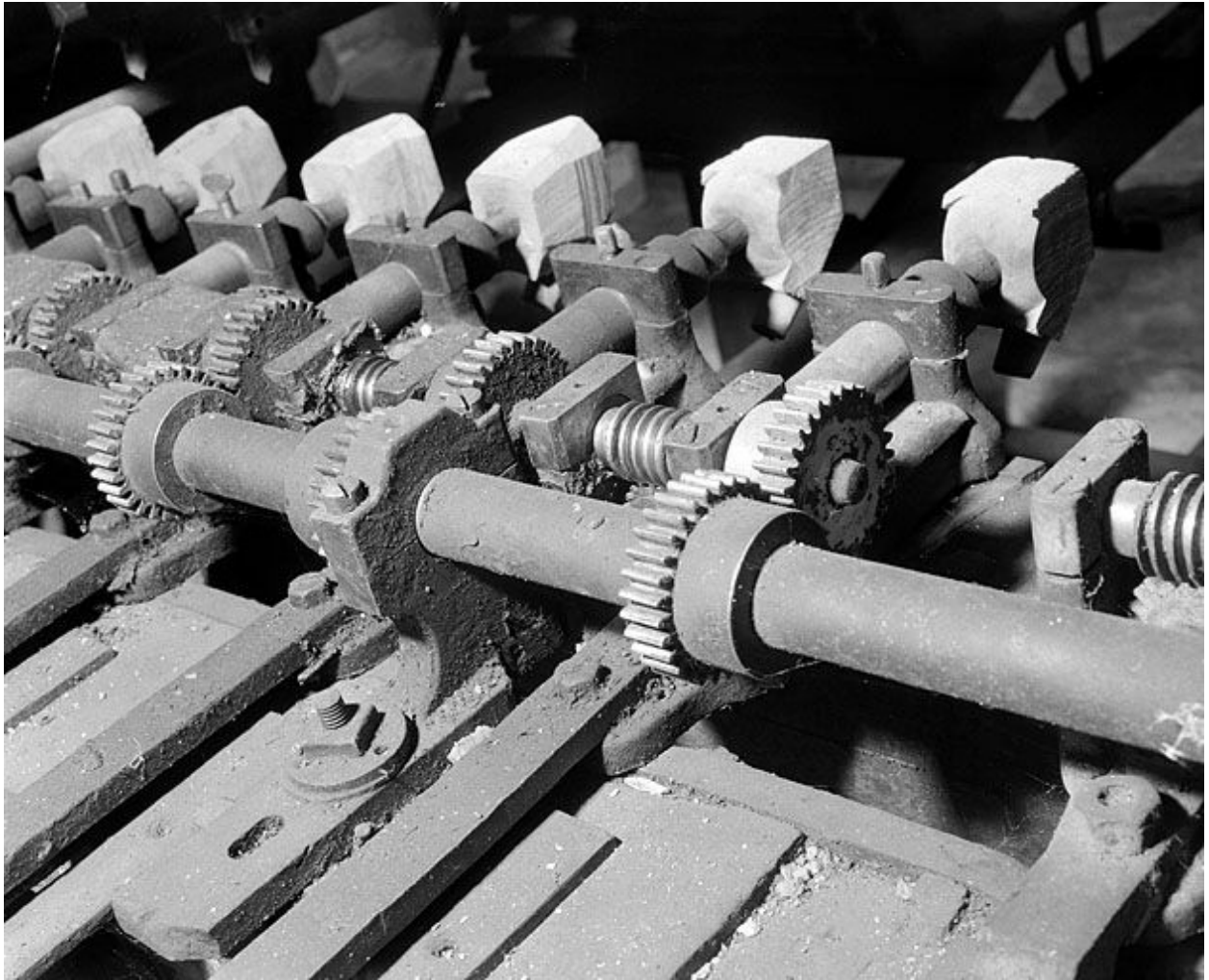
Face arrière : engrenages permettant la rotation simultanée des ébauchons.
