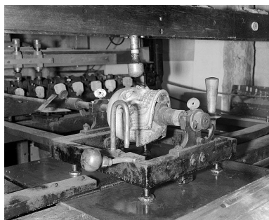
Support du modèle. Bougée à l'aide d'une poignée verticale et d'une poignée horizontale, cette partie du bâti mobile glisse sur une plaque métallique. Noter au-
