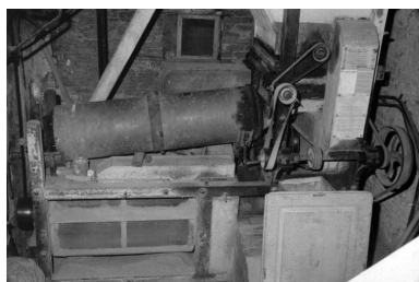
Intérieur : rez-de-chaussée, cage d'escalier, nettoyage combiné. Trémie d'alimentation à droite, cylindre trieur et décortiqueur au centre. Phot. Laurent Poupard IVR43_19883900010Z
