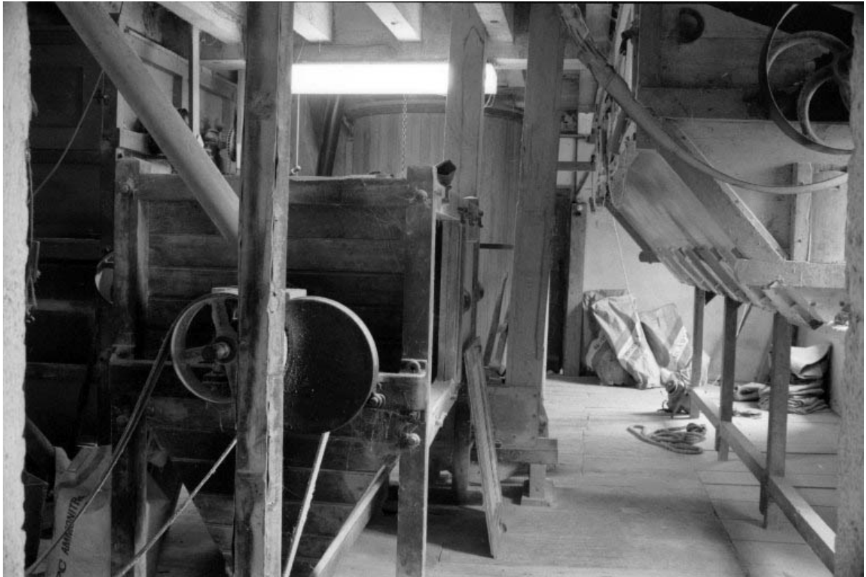
Intérieur : étage, salle de la bluterie. A droite extracteur à 6 pans, à gauche bluterie centrifuge, en arrière-plan mélangeur à farines.
