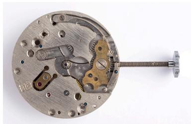
1er mouvement, côté cadran : vue d'ensemble. Il manque au centre la roue de minuterie et sa chaussée.
