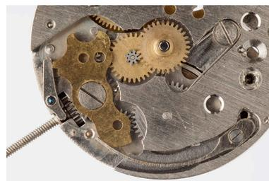
2e mouvement, côté cadran : mécanisme du remontoir.
