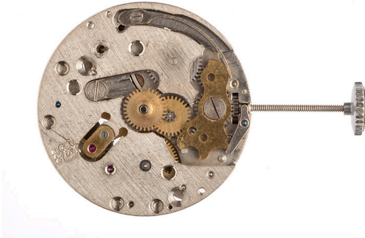
2e mouvement, côté cadran : vue d'ensemble.
