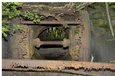
Turbine hydraulique à axe horizontal. Détail (les aubes ont disparu). Phot. Jérôme Mongreville IVR43_20057000284NUCA
