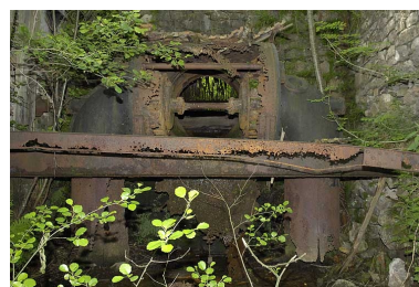
Turbine hydraulique à axe horizontal. Vue rapprochée. Phot. Jérôme Mongreville IVR43_20057000286NUCA
