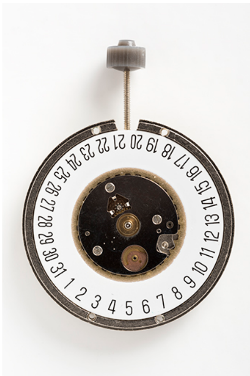
Mouvement France Ebauches FE 7221 : face côté cadran.
