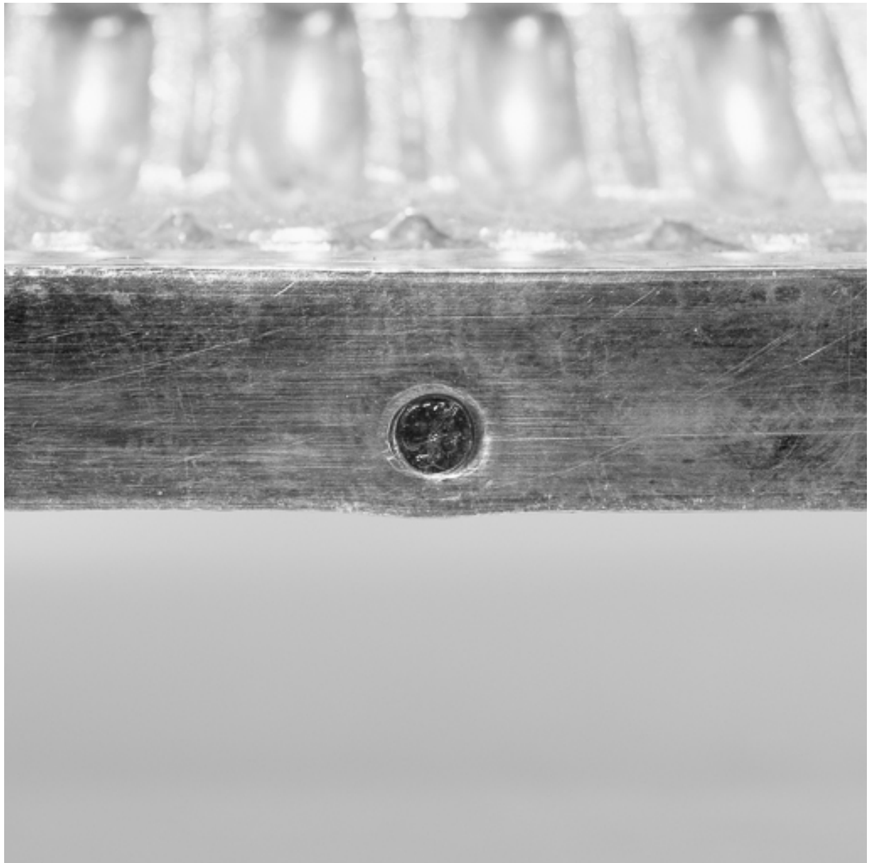
Détail de poinçon.
