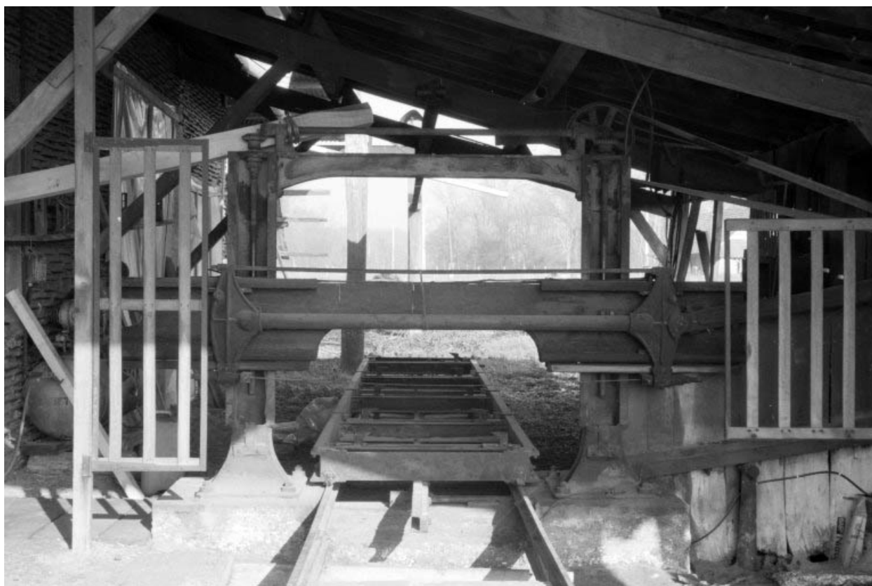
Scie "manchette" : châssis horizontal à lame unique. Le châssis est actionné par la bielle oblique à droite.
