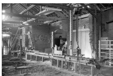
Intérieur de l'atelier de fabrication : scie Marcol. Phot. Laurent Poupard IVR43_19893900009Z
