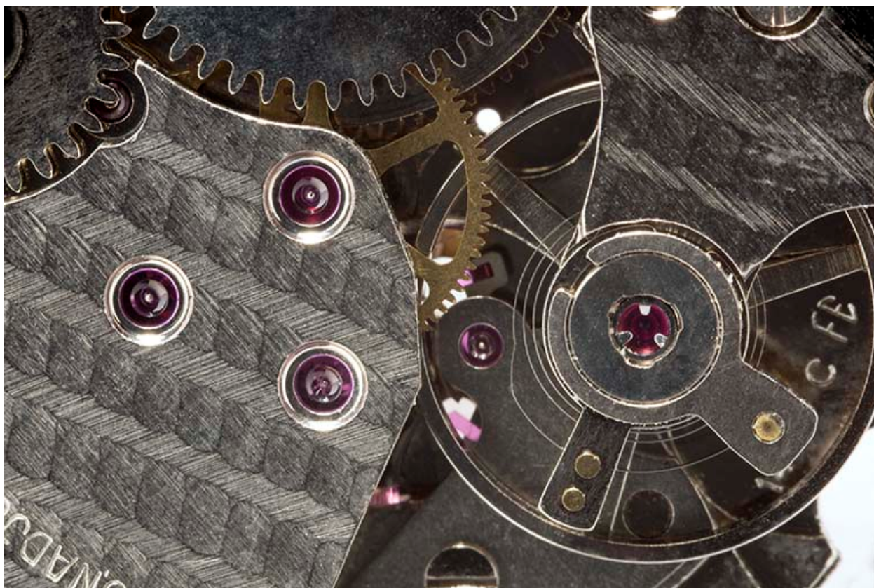
Mouvement FE 140-C : rubis sur le pont de rouage et amortisseur de chocs Epsilon 108.
