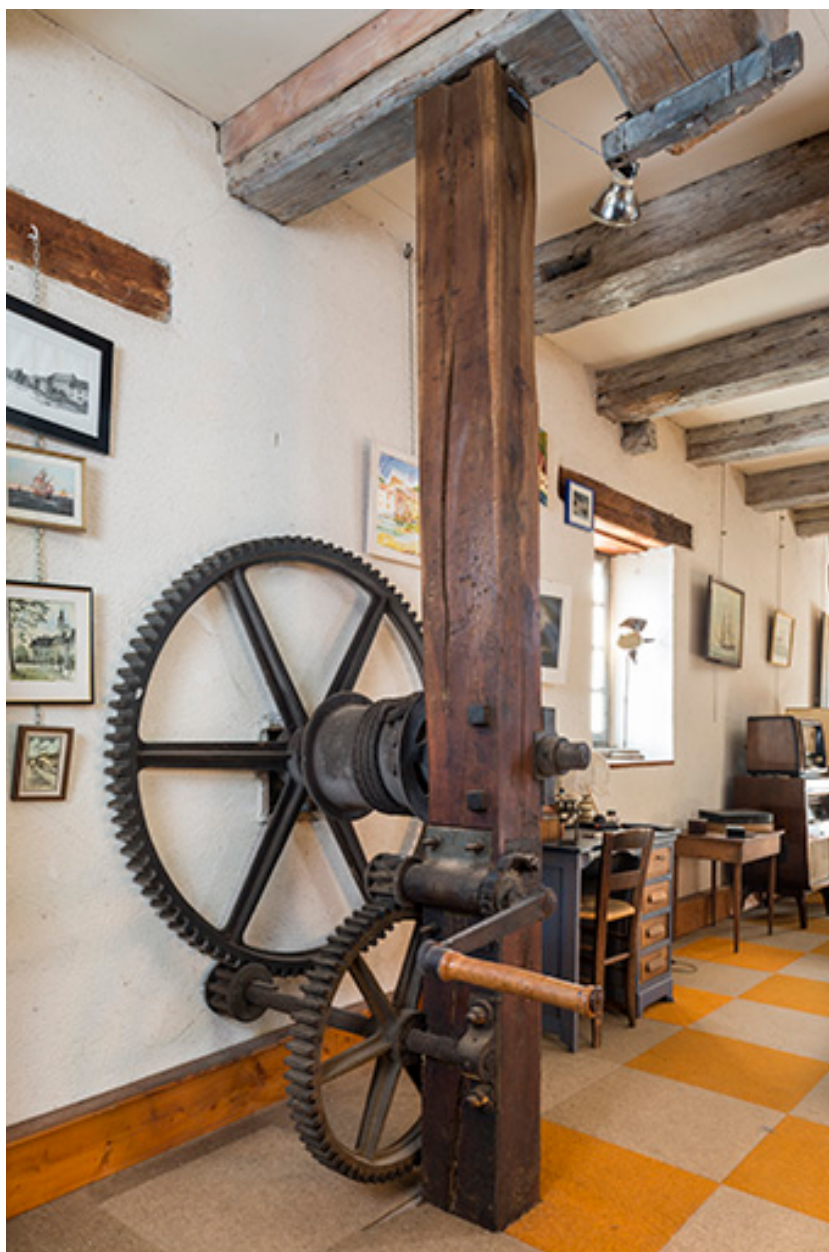
Premier étage. Système de levage (par manivelle et câble) de la roue suspendue (amont).
