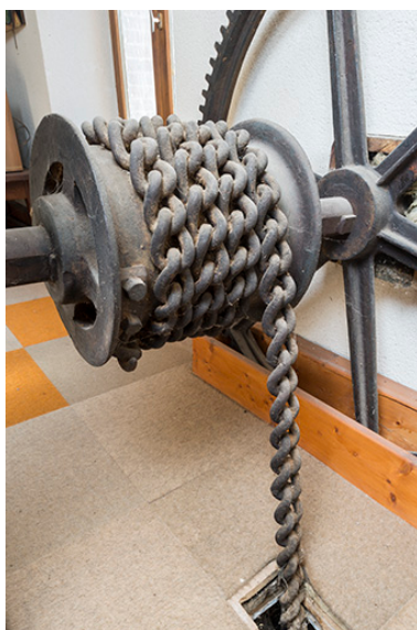
Système de levage de la roue suspendue (aval). Détail du mécanisme d'enroulement de la chaîne. Phot. Jérôme Mongreville IVR43_20162501622NUC4A
