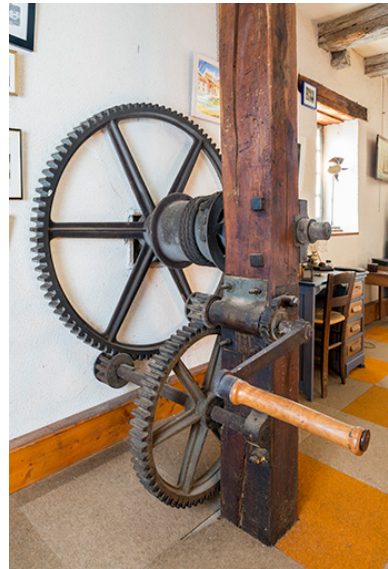
Premier étage. Détail de système de levage de la roue suspendue (amont). Phot. Jérôme Mongreville IVR43_20162501620NUC4A
