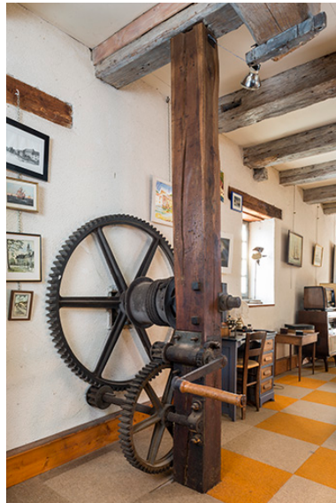
Premier étage. Système de levage (par manivelle et câble) de la roue suspendue (amont). Phot. Jérôme Mongreville IVR43_20162501619NUC4A
