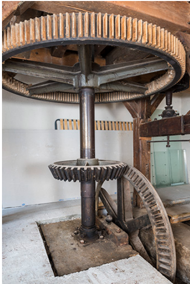
Beffroi des meules (est) et système de transmission par engrenages. Phot. Jérôme Mongreville IVR43_20162501615NUC4A
