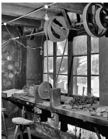
Intérieur : tour à polir et transmission. Phot. Yves Sancey IVR43_19903900376X
